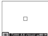
◆ Při nastavení vyšším než **180X** lze dobu expozice též nastavovat v krocích po  $\frac{1}{3}$  EV otáčením ovládacího volče. Doba expozice lze upravit i při polovičním stisknutí spouště.
