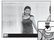
◆ Ostření i expozice lze též zablokovat tlačítky **AF-L** resp. **AE-L** (jestliže je vybrána možnost **AE/AF LOCK (ZÁMEK AE/AF)**) v nastavení **AE-L AE-AF-LOCK BUTTON (TLAČÍTKO ZÁMKU AE/AF)** v nabídce fotografování, uzamkne se po stisknutí tlačítka **AF-L** ostření i expozice; (95).
