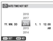
Stisknutím voliče vlevo nebo vpravo vyberte rok, měsíc, den, hodinu nebo minutu a stisknutím voliče nahoře nebo dole upravte nastavení. Chcete-li změnit pořadí zobrazení roku, měsíce a dne, zvýrazněte formát data a stiskněte volič nahoře nebo dole. Stisknutím tlačítka **MENU/OK** nastavte hodiny a možnosti displeje.
